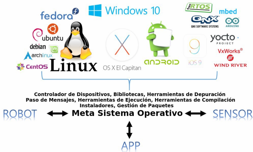
Figura 5.2: Esquema de la abstracción de hardware por ROS en distintos Sistemas Operativos. Imagen tomada de Pyo y cols. (2015).
