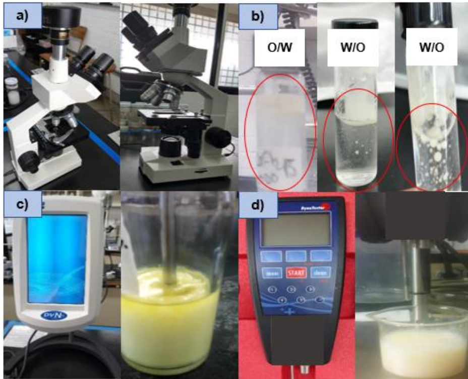
Figura 19. Equipos utilizados para obtener a) Tamaño de gota, b) Tipo de emulsión, c) Viscosidad y d) Tensión Superficial.
