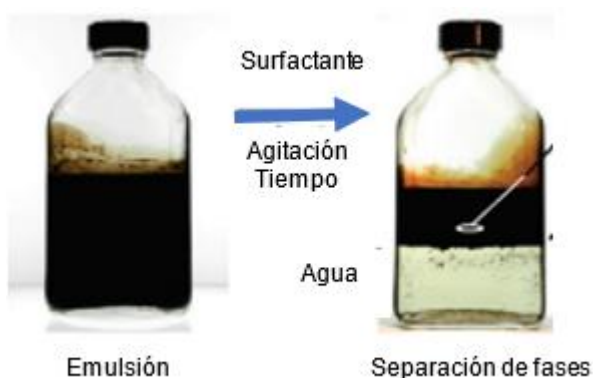
Figura 8. Prueba de la botella con diferentes muestras de petróleo. (Hirasaki, Miller, Raney, et al., 2011)
