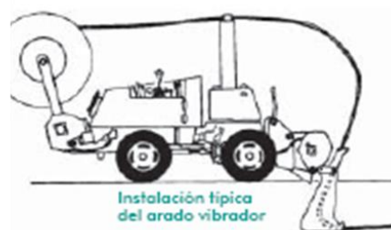
Figura 2.4 Instalación de Cable Armado. [4]
