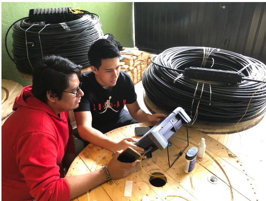
Figura 5.12 Realizando mediciones con OTDR.
