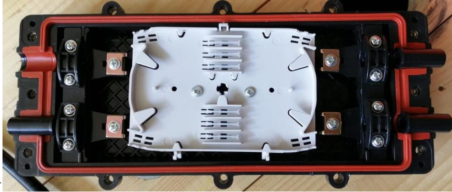
Figura 5.7 Charola de caja de empalmes de fibra óptica de 48 hilos.
