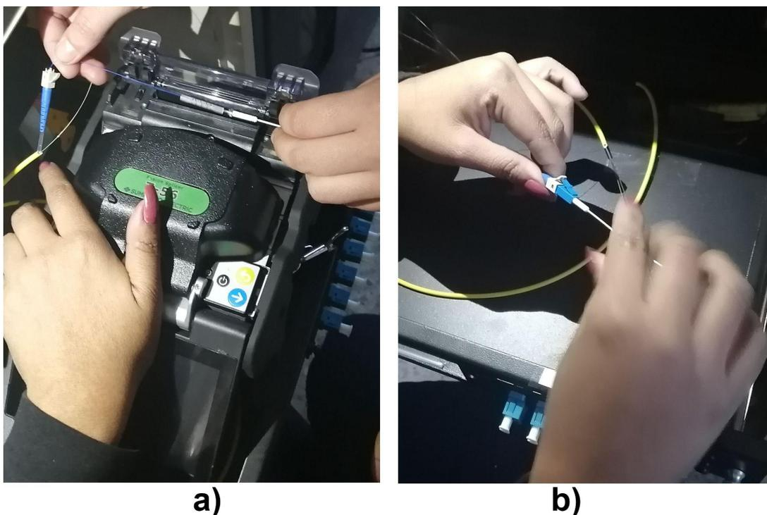
*Figura 3.18. Armado de conectores Lynx. a) Horneado de manga termocontráctil.*
