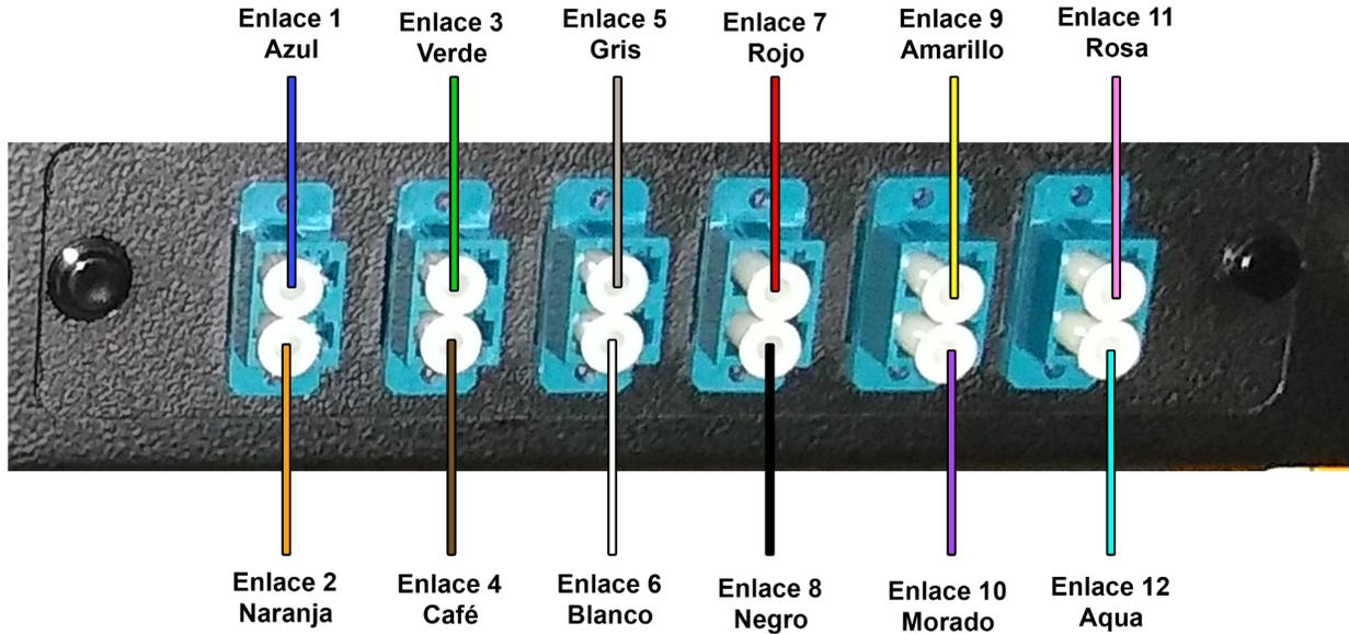
*Figura 3.27. Organización de conectores en tapas del distribuidor conforme a código de color.*
