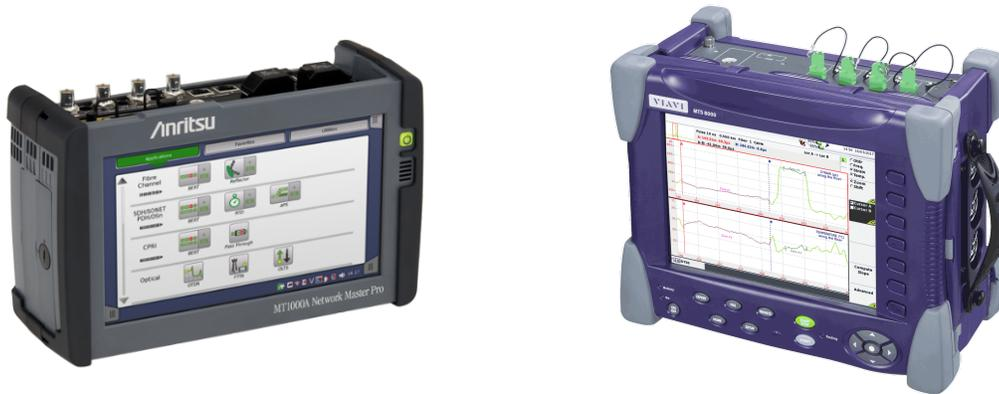
Figura 1.11. Reflectómetro óptico. [17]
