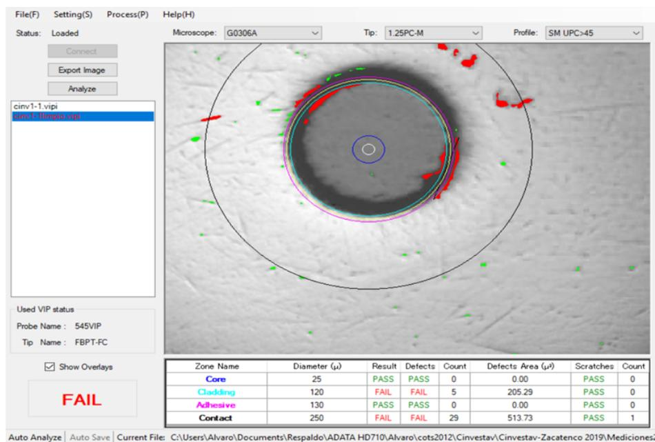
*Figura 2.16. Inspección del conector del Sitio 25, después de la limpieza.*
