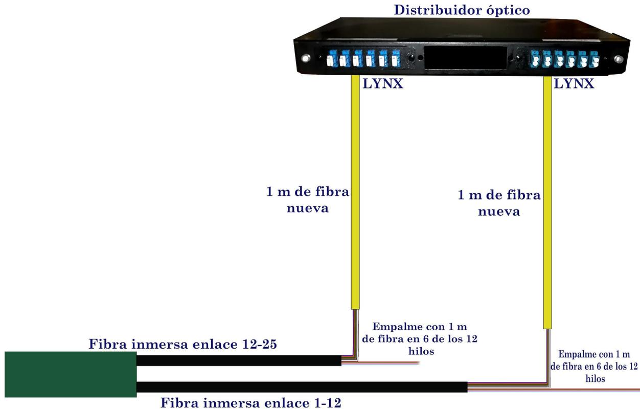
*Figura 3.12. Adición de 1 m de cable de fibra óptica.*
