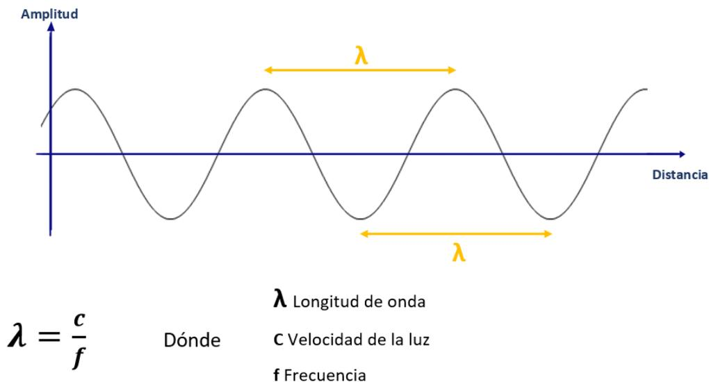
*Figura 1.2. Representación gráfica de longitud de onda y su relación con la velocidad de la luz y la frecuencia.*
