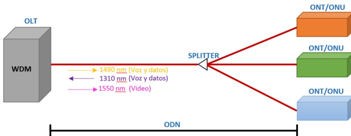
*Figura 1.9. Red óptica de acceso y de transporte.*
