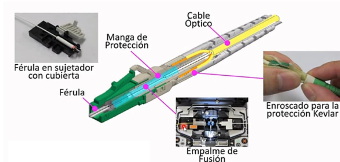
*Figura 1.21. Conectores ópticos basados en empalme de fusión. [25]*
