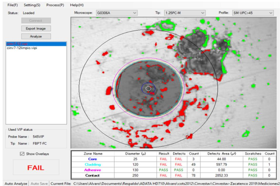
*Figura 2.15. Inspección de conectores en Sitio 25.*
