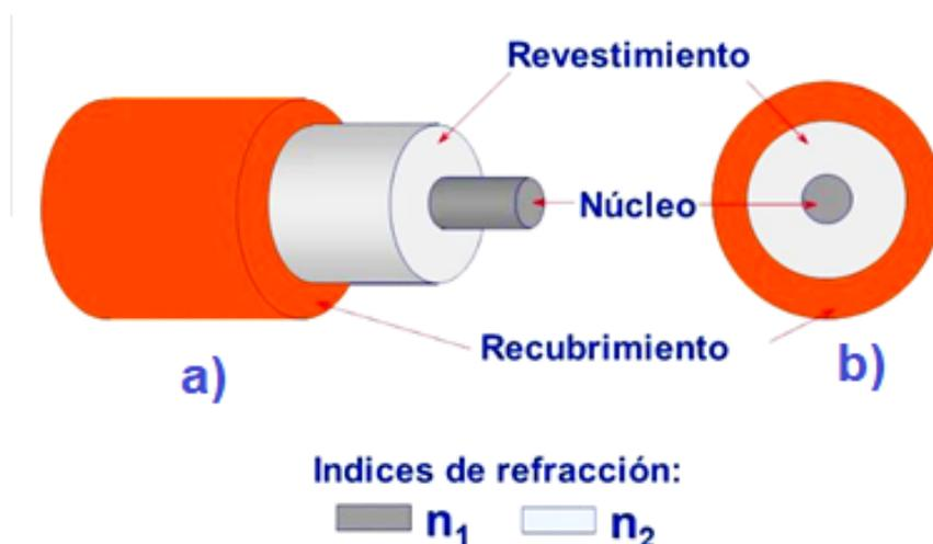
Figura 1.1. Estructura básica de la fibra óptica: (a) de perfil; (b) de frente. [2]
