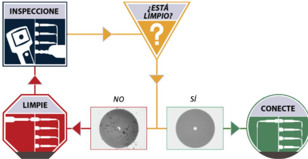
*Figura 2.10. Procedimiento de Inspección de conectores ópticos conforme IEC 61300-3-35 (2015). [28]*
