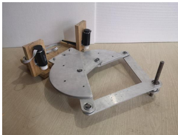
Figura 6-24 Mecanismo en aluminio con todos los elementos posibles montados.
