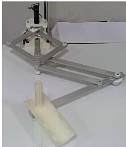
Figura 4-4 Nurse. Se muestra el mecanismo y el soporte para la mano y antebrazo del usuario.
