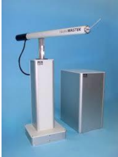
Figura 4-3 Haptic Master. La caja que se encuentra a un lado se encarga de realizar las fuerzas de oposición que el paciente recibirá al movimiento que intente hacer.
