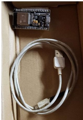
Ilustración 53. Dispositivo ESP32 que funcionará como servidor junto con un cable sencillo USB-Micro C para la transmisión de datos con protocolo Serial.
