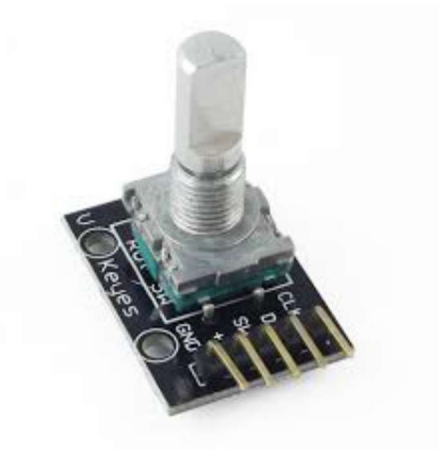
Ilustración 30. Módulo Encoder con perilla para medir posición angular.
