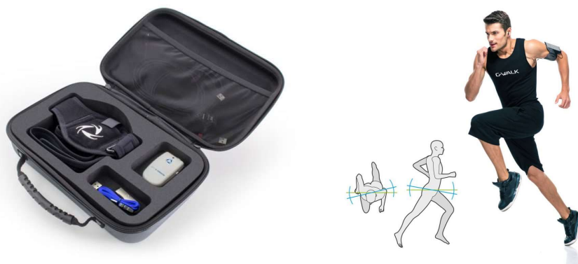
Ilustración 22. Sistema G-Walk para la captura de movimiento durante pruebas para evaluar la marcha, tomado de [53].
