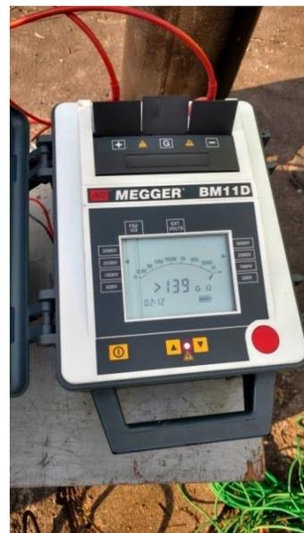
Para realizar esta prueba se utilizó un megger o megóhmetro que nos permite medir la resistencia de un aislamiento determinado. El nombre se debe a que la medida que se obtiene son  $M\Omega$ . Su principio de funcionamiento se basa en la ley de Ohm:  $R= V/I$ .
