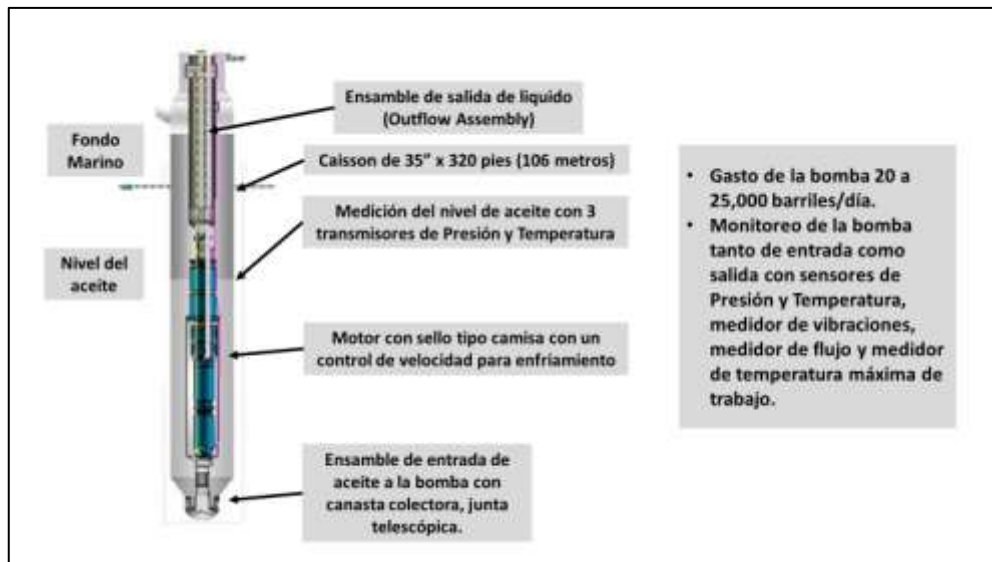
Figura 6.20 Configuración del Caisson Well y sistema de bombeo electro – centrífugo con ensamble de salida
