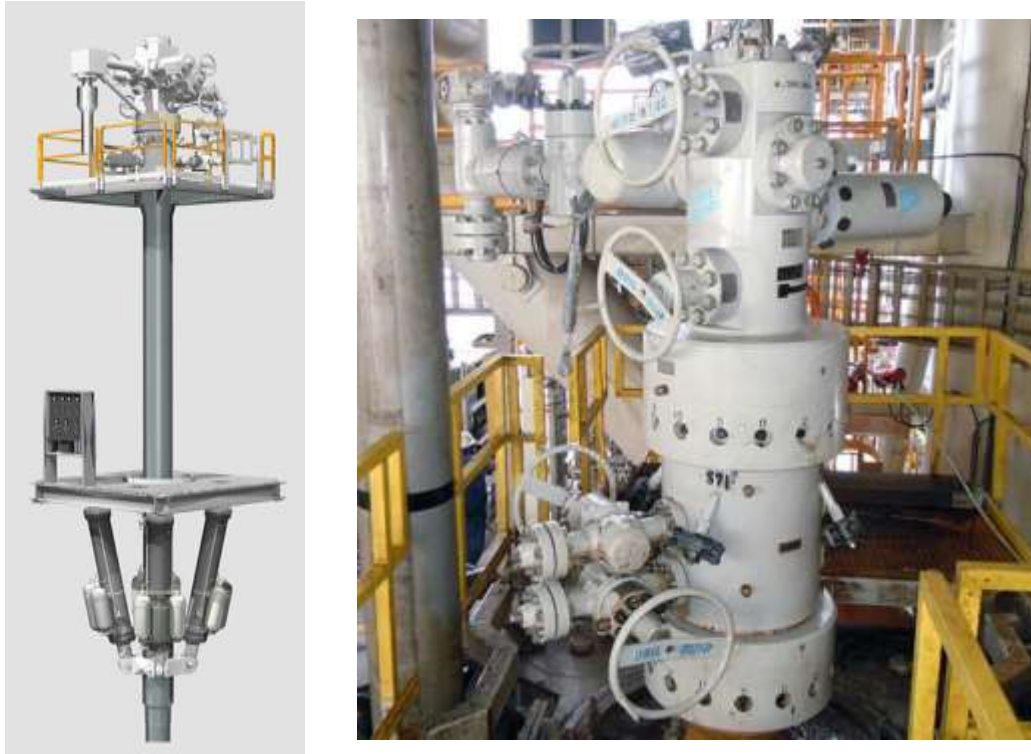
Figura 4.20 Componentes del riser vertical de producción para árboles secos para SPAR y TLP
