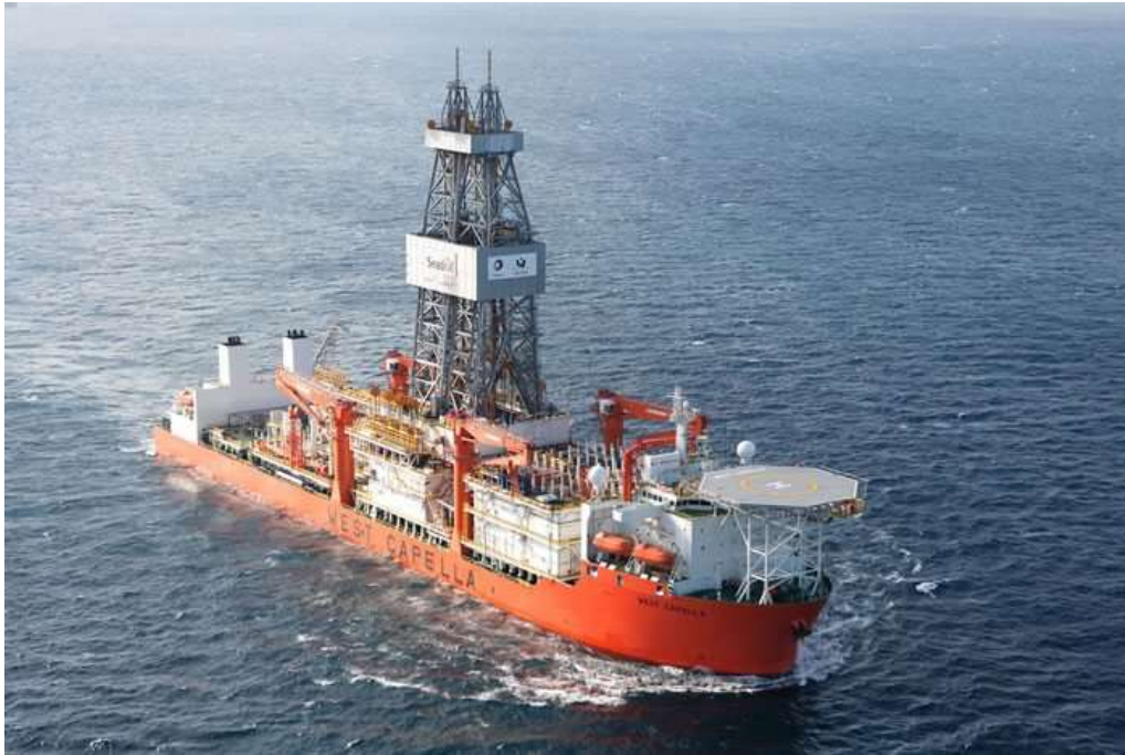
Figura 4.21 Barco perforador de pozos para AP y UAP o Deepwater Drillship Vessel
