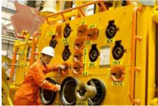
Figura 5.15 Árbol submarino con su ROV panel
