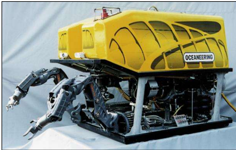
Figura XIII Ejemplo de ROV para intervenciones a pozos
