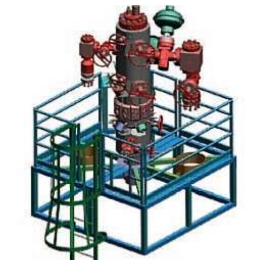
Figura 4.15 Estructura diseñada para tener acceso al Dry Tree
