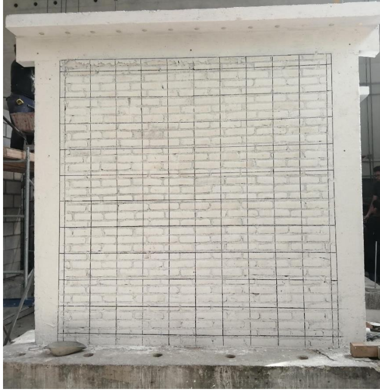
Figura 3.2. Muro de mampostería para prueba experimental.
