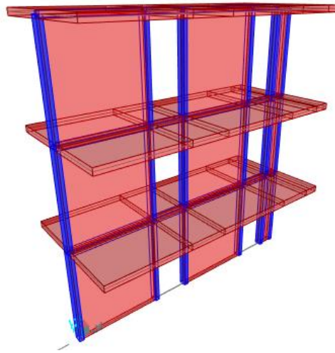
Figura 5.4. Edificio de tres niveles con elementos tipo cascarón y barra, modelado dinámico.
