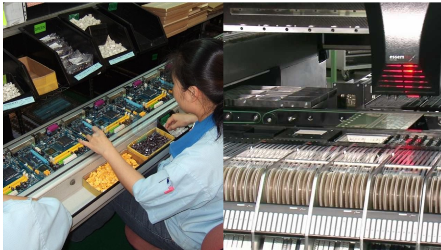
Figura 39. Inserción manual TH (izquierda) comparado con colocación automática 43 SMT (derecha). Modificado de (Smith, 2009) (EMST Marketing PVT. LTD., 2018).
