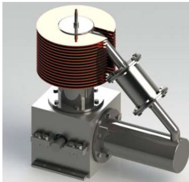
Figura 1.6 A la izquierda muestra la configuración tipo alfa (Jacek Kropiwnicki, Aleksandra Szewczyk, 2016) 20 , a la derecha están etapas del ciclo Stirling en configuración alfa (Mehrzaad Mojaver, Yazdan Alviri, Mehrnoosh Mojave, 2019) 21 , la figura inferior muestra un Motor Alfa 22
