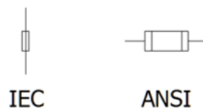
Figura 6. Símbolo de un fusible en estándar IEC y ANSI.
