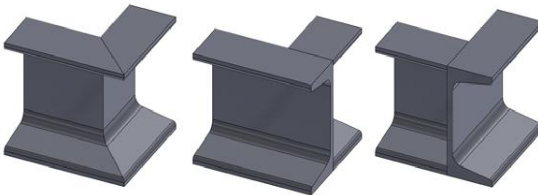
Figura 34. Tratamientos de esquina en un miembro estructural.
