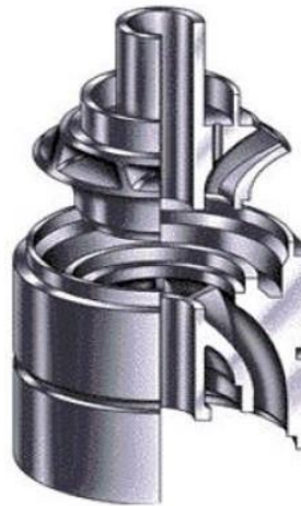
Figura 20.- Impulsor tipo mixto. Fuente: Extraído de [17]
