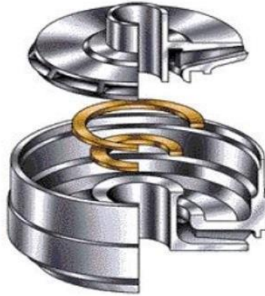
Figura 19.- Impulsor tipo radial. Fuente: Extraído de [17]
