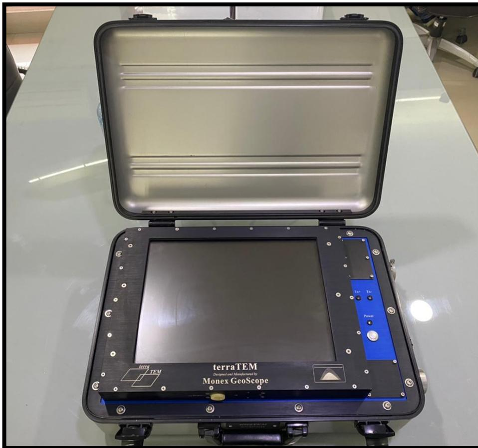
Figura 12 – Equipo: TerraTEM Monex GeoScope, utilizado para los trabajos de campo.
