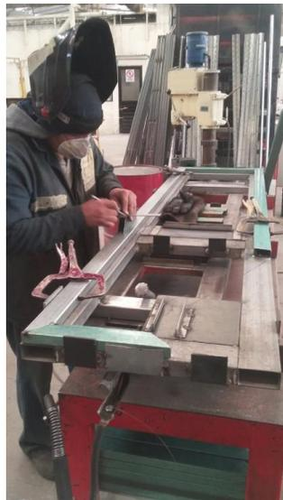
*Figura 27: Ajuste de plantilla para producción en serie <sup>[27]</sup>*
