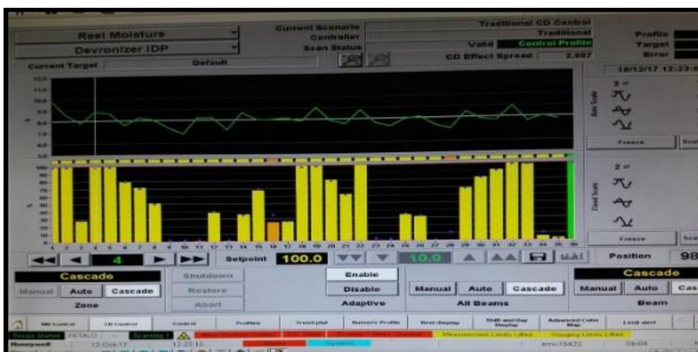
Figura 3.23. Despliegado para control perfil de humedad CD.
