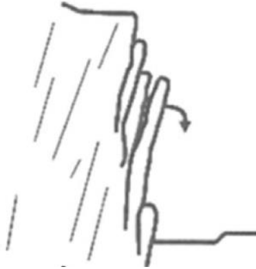
Figura 4. Inestabilidad por volteo (modificado de Ferrari et al., 2017).
