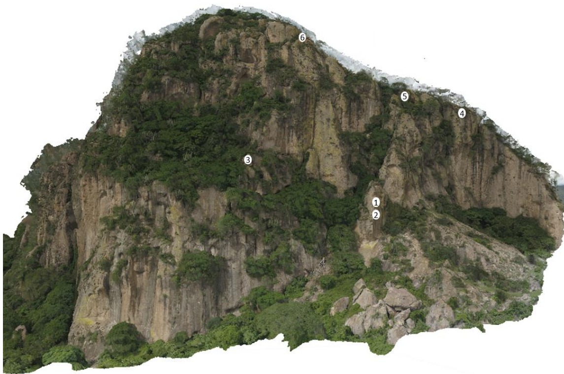
Figura 41. Imagen de la pared del Cerro Delgado con los sitios seleccionados de posibles colapsos para bloques de diversas dimensiones.
