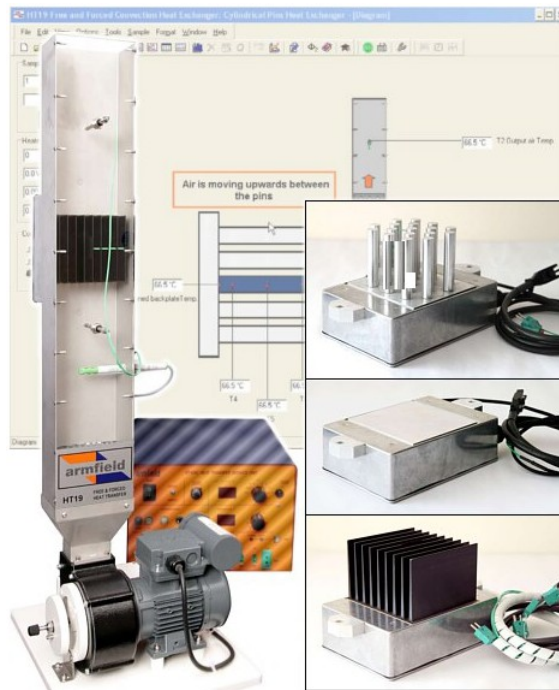
Figura 1.3 Módulo para estudiar convección libre y forzada Armfield-HT19-A
