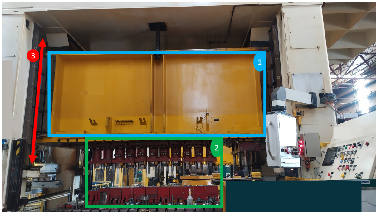
Figura 5.1: Máquina de troquelado. 1) Elemento de la máquina que realiza el movimiento vertical ( carrero ). 2) Elemento responsable de moldear la lámina de acero ( troquel ). 3) Eje en el cual se realiza el movimiento. El proceso de troquelación es secuencial por lo que cada golpe produce una pieza. La troqueladora puede aplicar una fuerza desde su propio peso hasta de 600 [ton].
