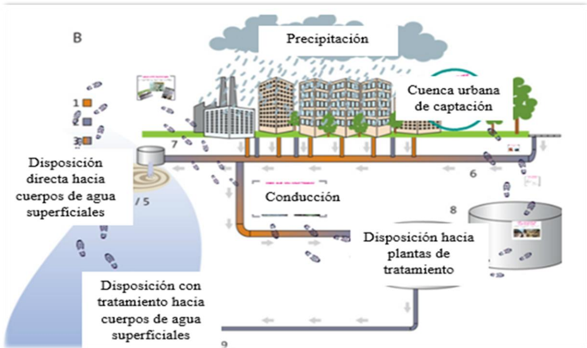
Figura 2. Esquema de un sistema de drenaje pluvial.
