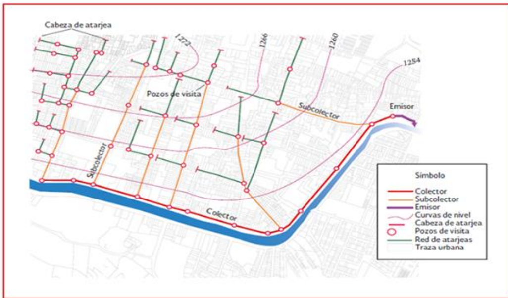
Figura 6. Configuración en perpendicular para colectores. (Comisión Nacional del Agua, 2016, pág. 7)
