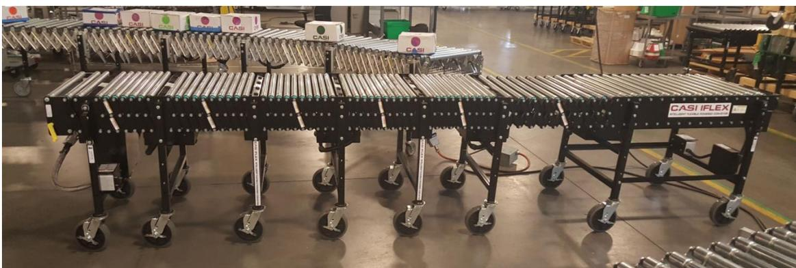
Figura 15. Ejemplo de un segmento de IFlex Conveyor
