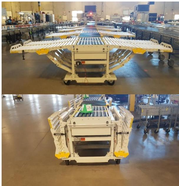
Figura 14. Intersección Tee expandida y contraída
