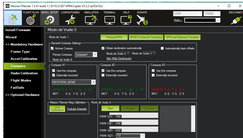
Figura 3.18: Sección del Mission Planner, para calibrar la brújula
