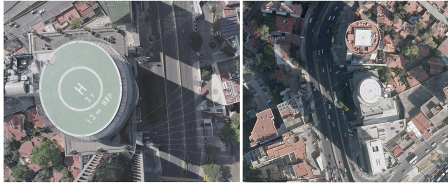
Figura 2.18: Inclinación de los objetos en imágenes aéreas, en la izquierda imagen capturada con un UAV y en la derecha una imagen capturada con una cámara fotogramétrica con aeronave tripulada.
