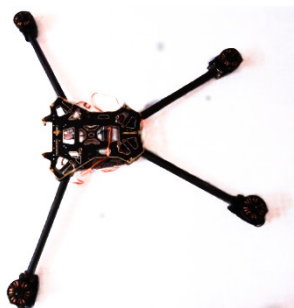
Figura 3.5: Integración de los motores con el frame
