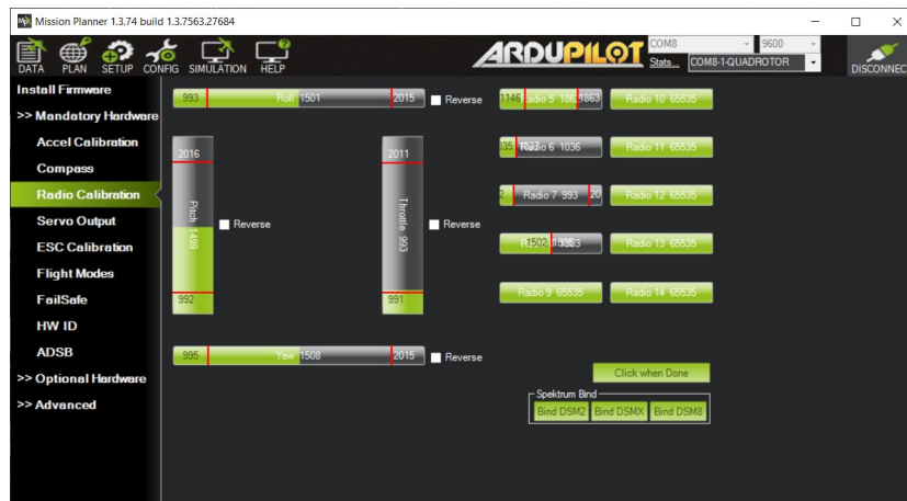
Figura 3.15: Sección del Mission Planner de calibración la emisora RC, marca de los límites de las señales
