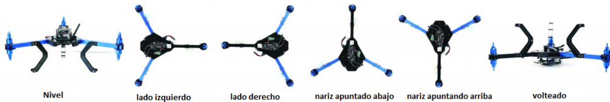
Figura 3.17: Posiciones para la calibración de ejes del UAV (ArduPilot-Community, 2017)
