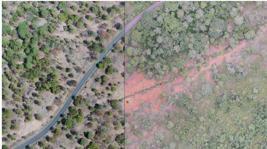
Figura 4.26: A la derecha el ortomosaico obtenido con el prototipo de UAV y a la izquierda el obtenido con el UAV comercial, se aprecia una continuidad en ambos
