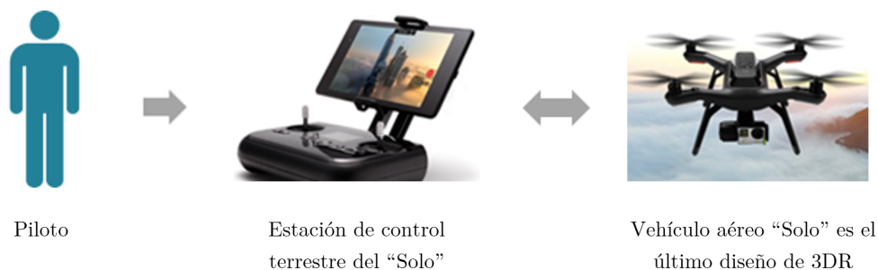
Figura 1.9: Diagrama de comunicación de los Vehículo aéreos (Scan, 2017)
