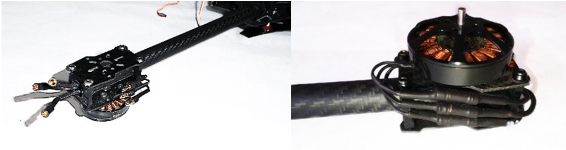
Figura 3.6: Conexión de los motores con los ESC
