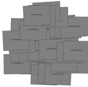
Figura 2.16: Vuelo en modo manual, con el disparador automático, tratando de cubrir la zona de estudio, sin algún plan de vuelo (Nex and Remondino, 2014).
