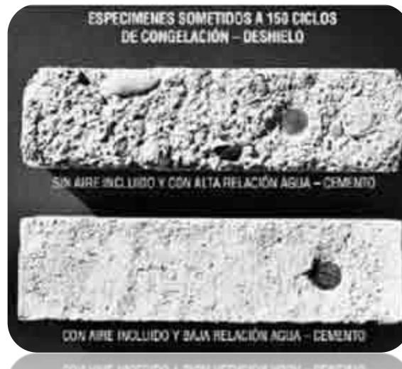
Ilustración 3 Comparación de cilindros de concreto sometidos a 150 ciclos de congelamiento y deshielo. El aire incluido permite que disminuyan las afectaciones provocadas por los cambios volumétricos del concreto.
