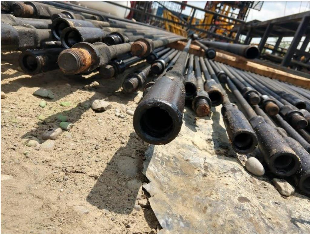
**Figura 8** Varillas de succión
