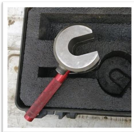
**Figura 40** Celda de carga tipo Herradura
