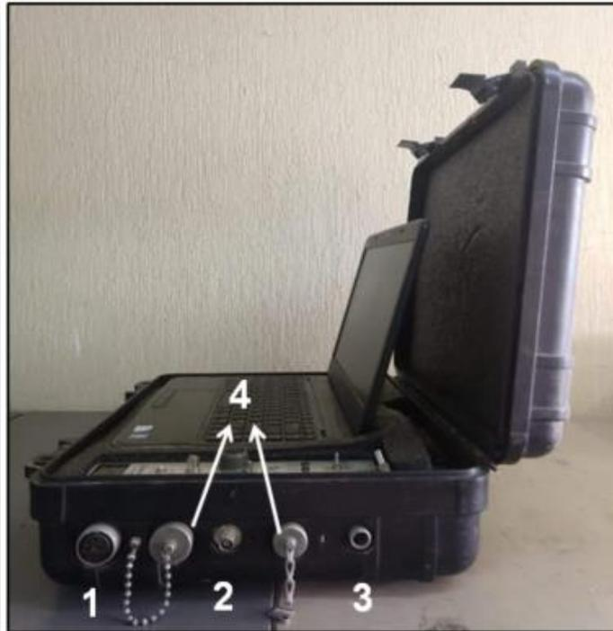
Figura 36 Entradas (Input) del Analizador de Pozo
