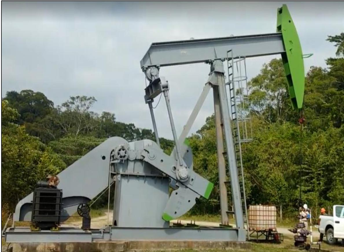
**Figura 14** Unidad de Bombeo Mecánico Convencional
