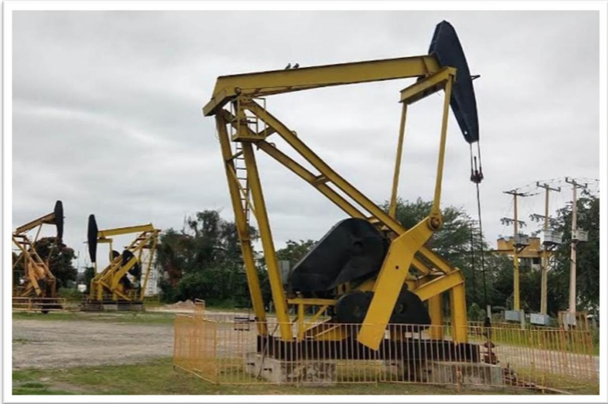
**Figura 16** Unidad de Bombeo Mecánico Mark II
