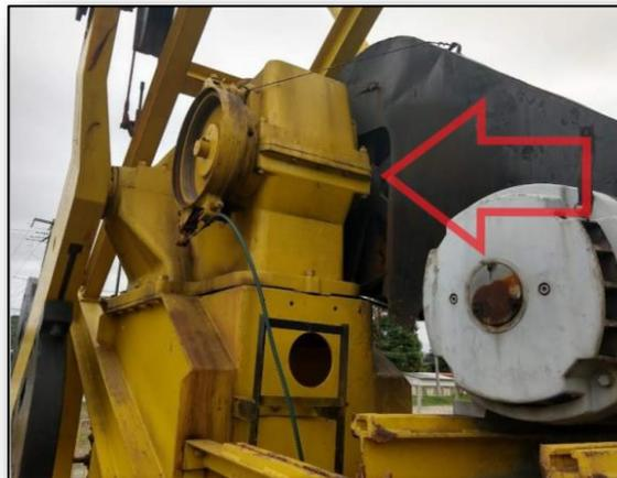
Figura 12 Caja de engranes instalada en la unidad de bombeo
