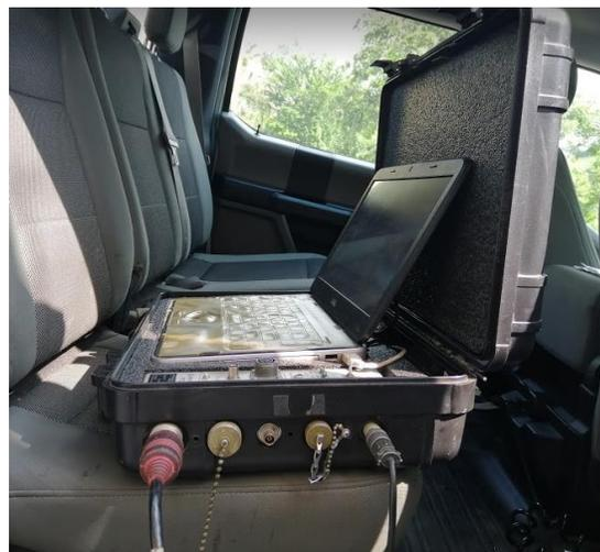
**Figura 87** Conexión del cable a la entrada principal del Analizador de Pozo
