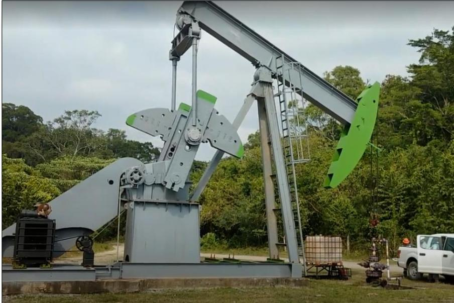
**Figura 103** Unidad de Bombeo Convencional detenida en el final de la carrera descendente para la instalación del PRT.
