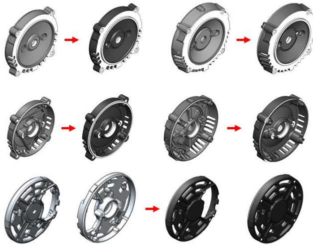
Figura 3.15 Propuesta de tapas de aluminio para hierro fundido
