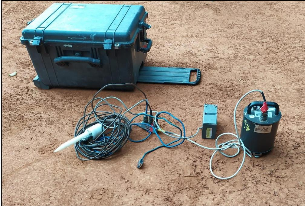
**Figura 4.1.** Instalación típica del sismógrafo Guralp CMG-6TD para la medición de ruido sísmico. Los componentes necesarios para un buen funcionamiento son el sensor, una batería para suministrar energía, el GPS para que el tiempo sea el correcto y los cables para las conexiones entre todos estos componentes.
