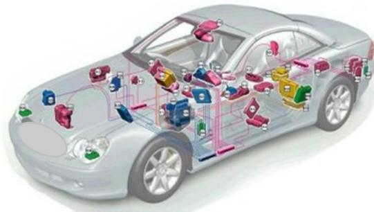
Figura 11. Ejemplo de localización de diferentes módulos electrónicos en un vehículo.
