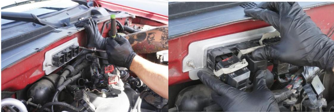
Figura 13. Ejemplo de puntos de sujeción de un módulo electrónico, *Escape 2006*.
