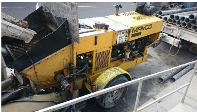
Figura 24. Bomba estacionaria de concreto.
