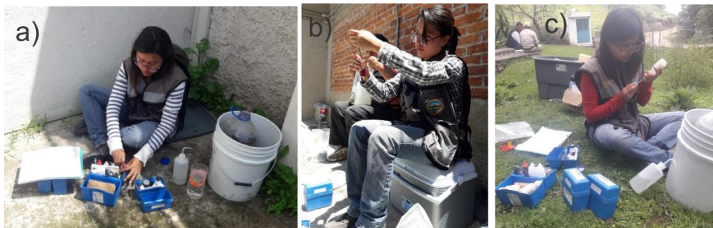
Figura 16. Medición de parámetros físico-químicos en campo por medio de los Kits marca LaMotte. a) se observan los 4 kits que se utilizaban en campo y la botella que se encuentra en el bote contiene los residuos líquidos, b) se observa el paso 5 para medir dureza total donde se presiona lentamente el titulador mientras se agita suavemente el tubo de vidrio hasta que la muestra cambie a color azul y c) se observa el paso 3 para medir alcalinidad donde se llena la jeringa de titulación para posteriormente insertarla en el tubo de vidrio con la solución.
