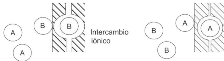
Figura 10. Proceso de intercambio iónico. Tomado de Appelo y Postma (2005)
