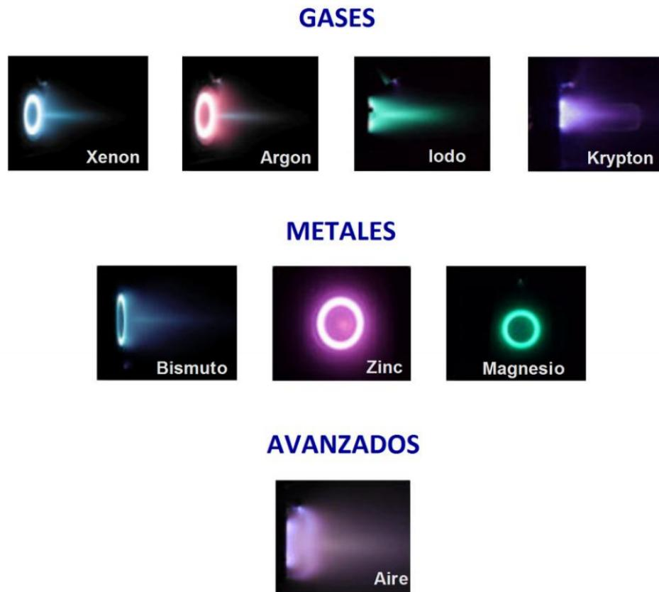
Figura 5-9: Distintos tipos de propelentes utilizados en propulsores Hall. Tomada de [77].
