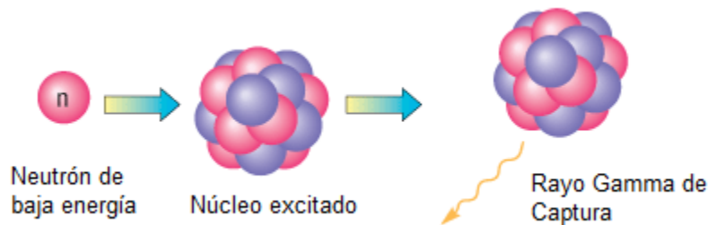
Ilustración 1.6 Captura de neutrones. Tomado de Schlumberger Oilfield Glossary. Traducido por el autor.
