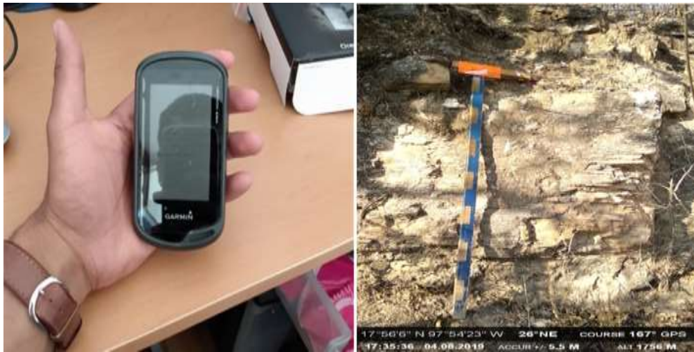
Figura 4. Instrumentos utilizados en campo. A la izquierda receptor GPS Garmin Oregon 650t y a la derecha Báculo de Jacob.
