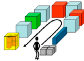
CHAKU-CHAKU (Línea Flexible en "U")
