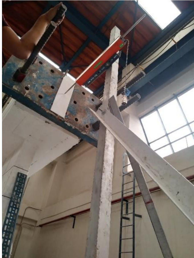
Figura 18. Placa de confinamiento en el cabezal superior.
