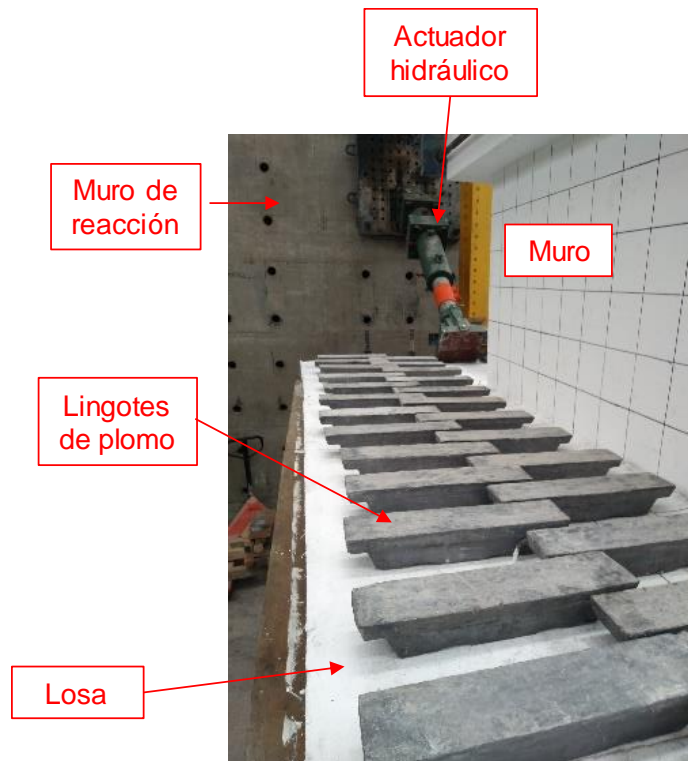
Figura 13. Lingotes sobre la losa
