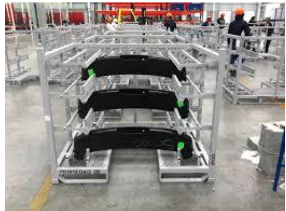
Fig. 30 rack de almacén y embarque
