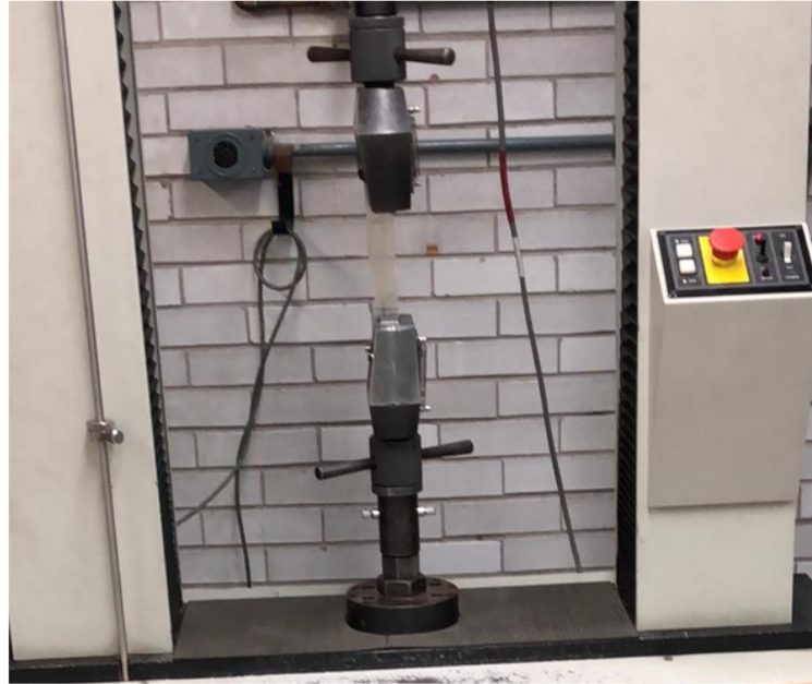
Figura 2.2: Ensayo de tracción en un probador uniaxial de una muestra de fibra de vidrio, realizado en la Facultad de Ingeniería de la UNAM
