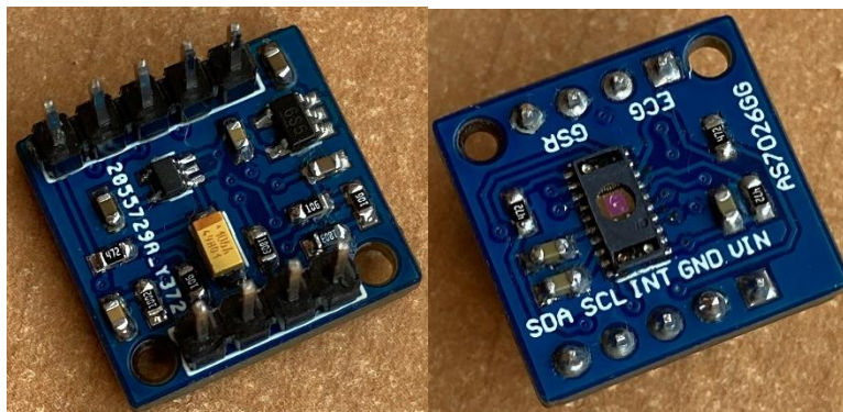
Figura 64. PCB del sensor biométrico AS7026GG
