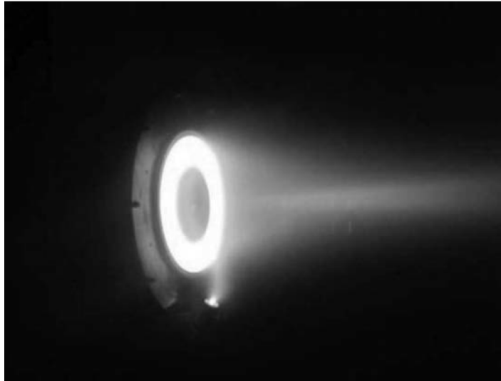
Figura 2.36: Propulsor por efecto Hall en operación. Taylor, 2017
