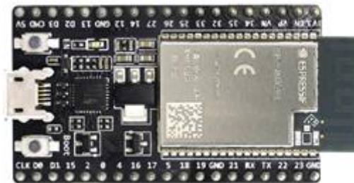
Figura 4.1 Tarjeta de desarrollo ESP32-DevKitC [24].
