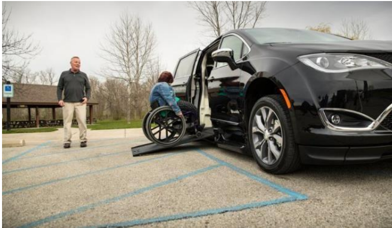
Fig. 11. Camioneta modificada con rampa de acceso. [19]
