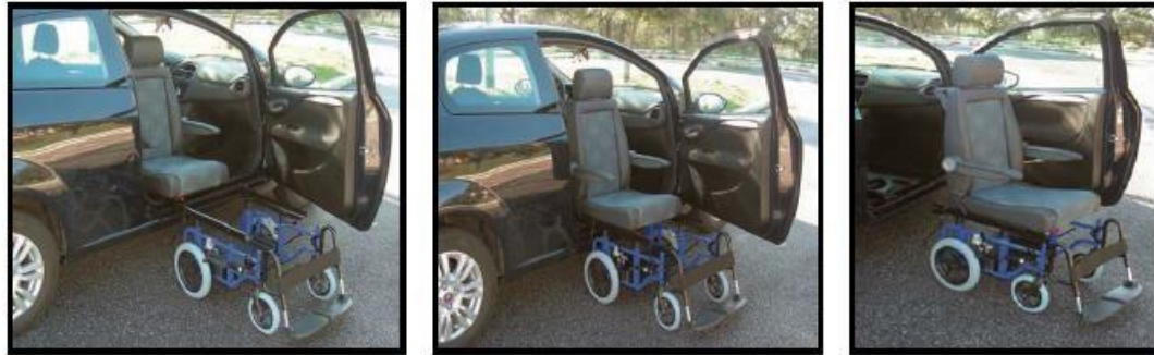
Fig. 9. Asiento de vehículo híbrido convertido en silla de ruedas. [18]
