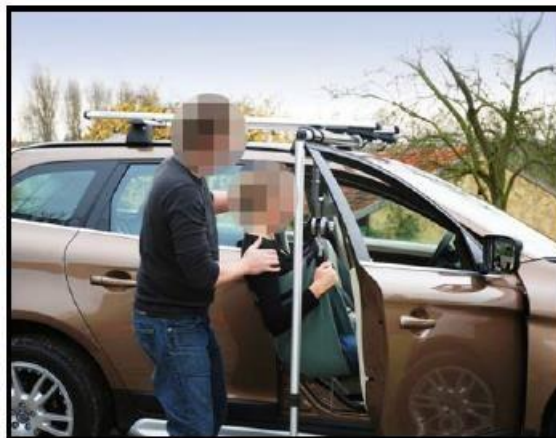
Fig. 10. El elevador portátil de personas operando. [18]
