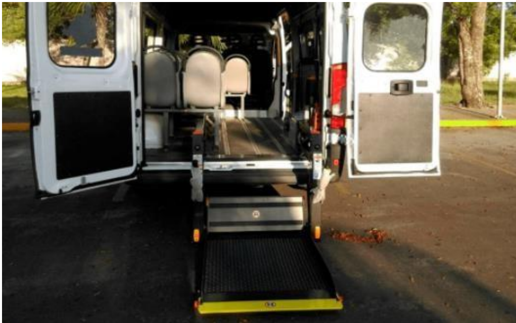
Fig. 12. Van estándar con plataforma fija. [19]
