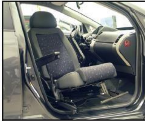
Fig. 7. Asiento basculante en operación. [18]
