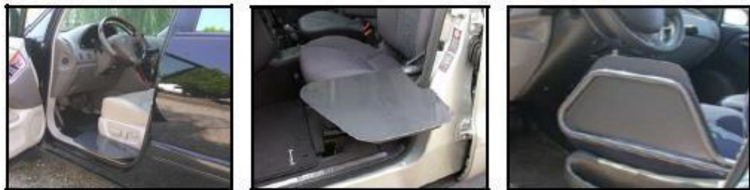
Fig. 4. Superficie de transferencia instalada en un automóvil. [18]
