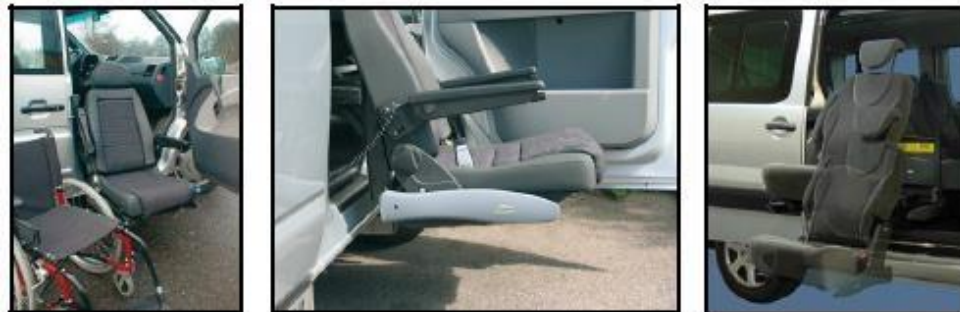
Fig. 8. Utilización del dispositivo giratorio elevable. [18]
