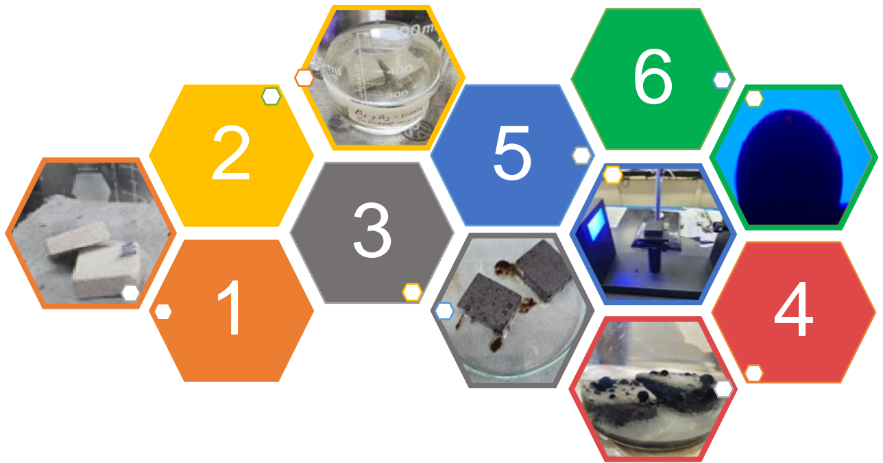
Figura 5.14 Procedimiento realizado para pruebas de ángulo de contacto: 1) Preparación de muestras, 2) Saturación en salmuera, 3) Saturación en aceite, 4) Añejamiento en nanofluido, 5) Medición de ángulo de contacto, 6) Análisis de la medición
