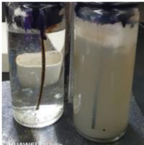
Figura 5.7 Medición de desplazamiento de aceite en capilar al tiempo cero: izquierda desplazamiento por salmuera, derecha desplazamiento por nanofluido.
