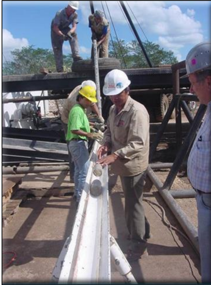
Figura 3.3. Operaciones de perforación y recuperación de núcleos en la Hacienda Yaxcopoil.
