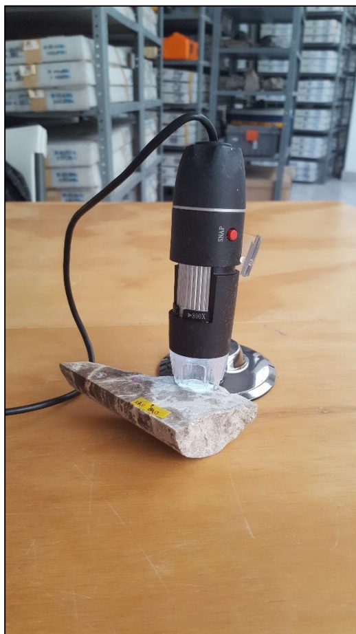
Figura 4.3. Captura de imágenes de fracturas y microestructuras de un núcleo del pozo Yax-1.
