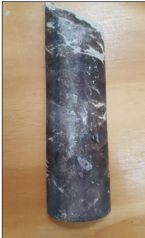
Figura 4.2. Núcleo del pozo Yax-1 con aceite impregnado, en el cual se observa como es el trazado de las líneas de referencia vertical del pozo.
