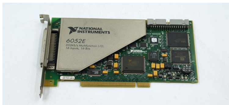
Figura 10. Ejemplo de placa de adquisición de datos. Su labor es esencial dentro de un sistema DAQ, pues en ella se realizan la lectura de la señal analógica, así como su acondicionamiento y codificación a una señal digital que pueda ser interpretada por una computadora. Las características principales por considerar durante su diseño son los números de canales, tasa de muestreo, protocolo de comunicación y valores máximos de corriente/voltaje admitidos (McConnell, 2014).
