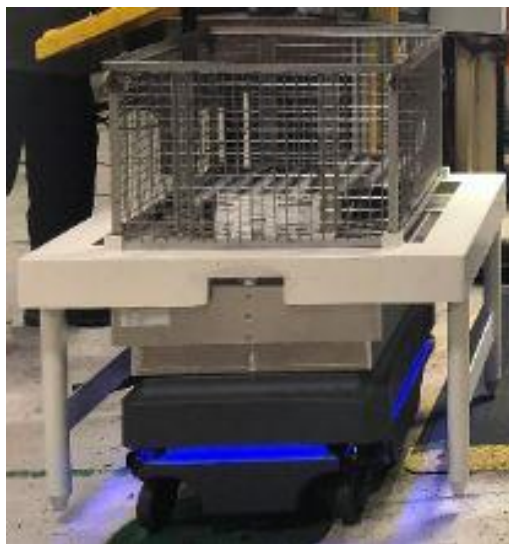
Imagen 3.14 Carro transportador instalado en el MiR®.
