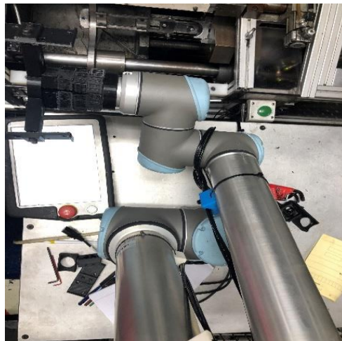
Imagen 3.5 Herramental impreso en 3D montado al cabezal del robot.
