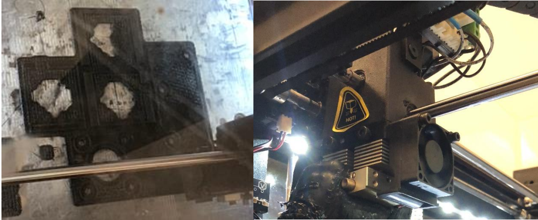
Imagen 3.4 Impresión en 3D del herramental.
