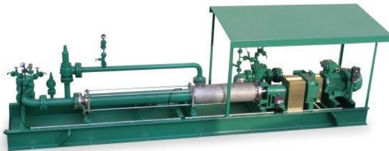
Ilustración 36. Bomba multifásica convencional marca NEMO.
