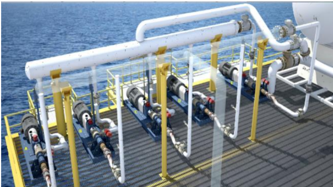
Ilustración 34. Diagrama del arreglo de bombas en separadores de primera etapa [6].
