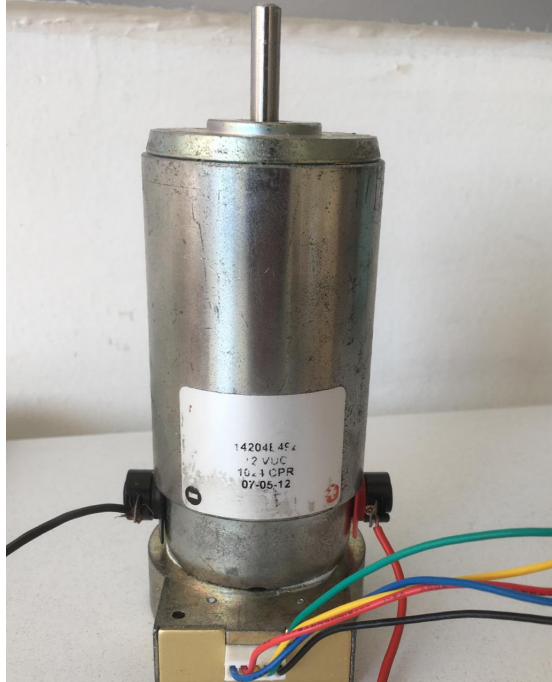
Figura 4.1: Motor Pittman 14204 12.0 V con codificador
