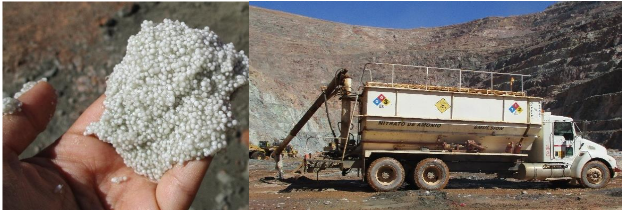
Figura 3 Mezcla Emulsión-ANFO (Izquierda), Camión mezclador (Derecha).
