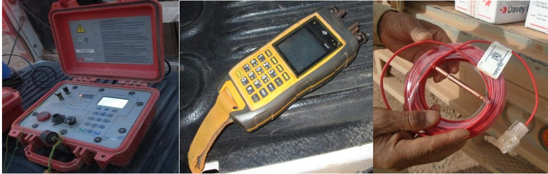
Figura 4 Sistema de iniciación electrónico utilizado en las pruebas.
