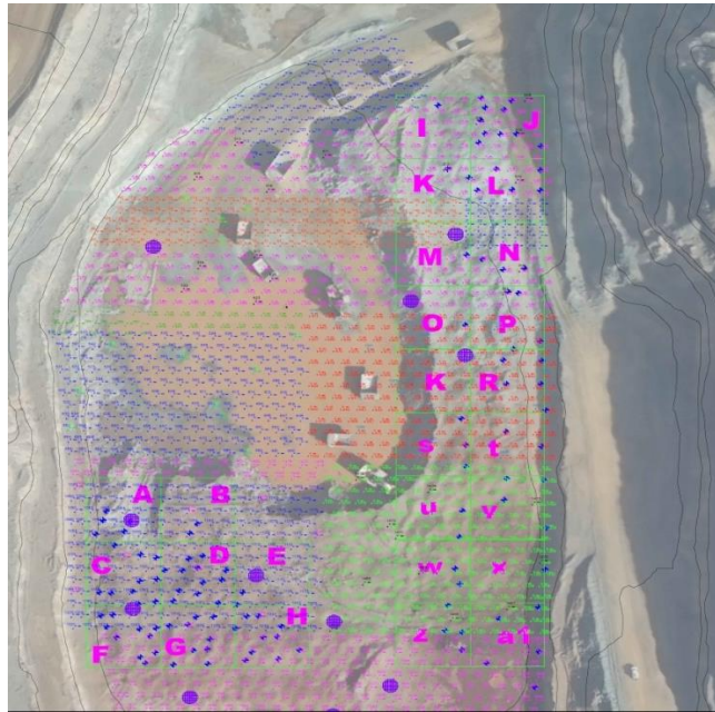
Figura 14 Plano de banco: Puntos de muestreo (Letras y puntos). Voladuras cargadas (cuadrículas)
