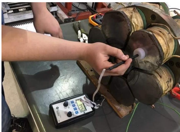
Ilustración III.2.3 Medición de Flujo Magnético en la PAU
