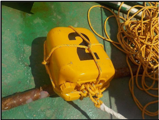
Imagen 28 Boyas utilizadas para marcar posibles riesgos submarinos (Tomada de Petróleos Mexicanos, 2019)
