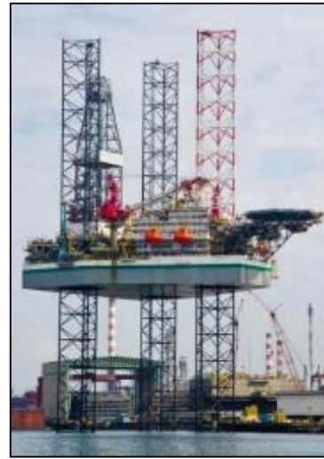
Imagen 6 Plataforma Auto Elevable Petrolera "Spud Can" (Tomada de Petróleos Mexicanos, 2015)
