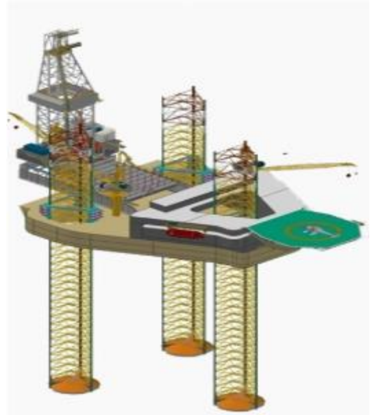
Imagen 17 Plataforma Auto Elevable "Spud Can Footing" con 3 piernas "Trused" (Tomada de Sheap&Offshore, 2014)
