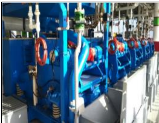
Imagen 15 Temblorinas de una Plataforma Auto Elevable (Tomada de NOV, 2019)
