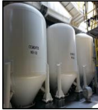
Imagen 12 Silos de una Plataforma Auto Elevable (Tomada de Petróleos Mexicanos, 2019)
