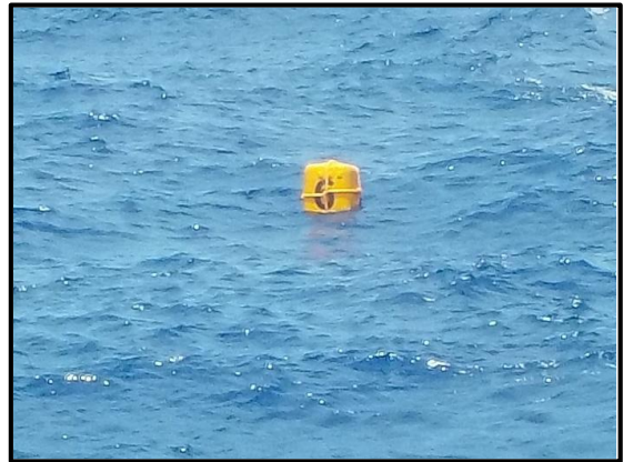
Imagen 28 Boyas utilizadas para marcar posibles riesgos submarinos (Tomada de Petróleos Mexicanos, 2019)
