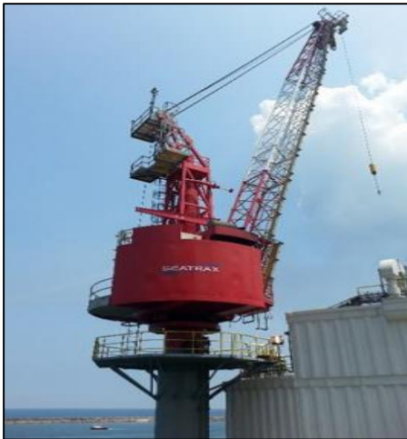
Imagen 19 Grúa de Carga con capacidad de 70 ton de una Plataforma Auto Elevable (Tomada de Petróleos Mexicanos, 2016)
