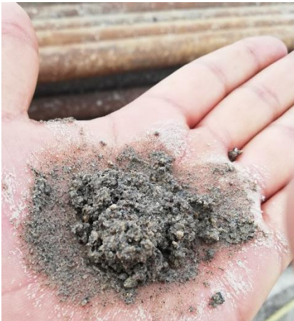
Ilustración 51 Muestra de suelo a los 200 metros de profundidad. La muestra presentada no es para análisis de campo, pero es representativa para observar el tipo de material (arenas). Fuente: Elaboración propia.
