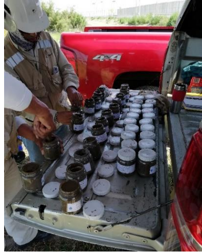
Ilustración 36 Identificación y clasificación de muestras de suelo en los primeros 54.60 metros.
