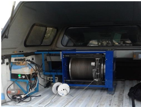
Ilustración 44 Equipo con cable de acero para registro eléctrico. Fuente: Elaboración propia.
