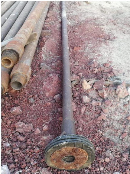
Ilustración 61 Pistón con punta de neopreno. Fuente: Elaboración propia.
