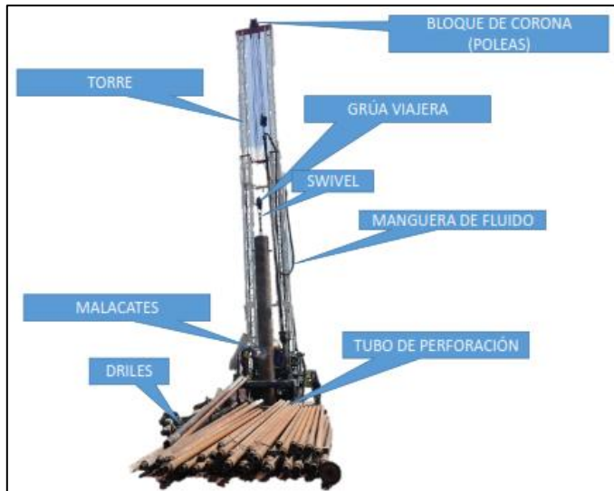
Ilustración 21 Componentes del equipo de perforación de sistema rotario.
