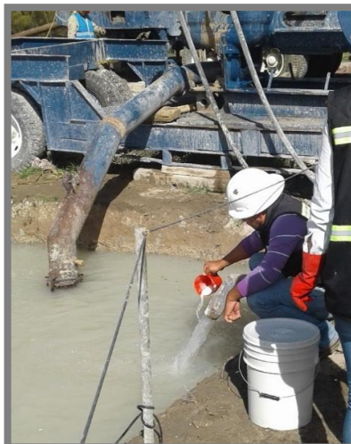
Ilustración 33 Prueba de Viscosidad con Marsh Funnel. Fuente: Elaboración propia.
