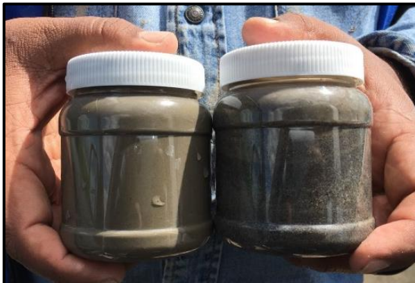
Ilustración 35 Extracción de muestras de suelo en los primeros dos metros. Fuente: Elaboración propia.
