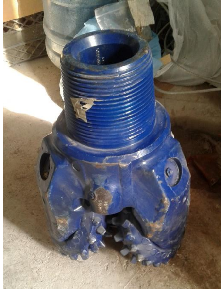
Ilustración 17 Brocal tricónico con incrustaciones de metal. Fuente: Elaboración propia.
