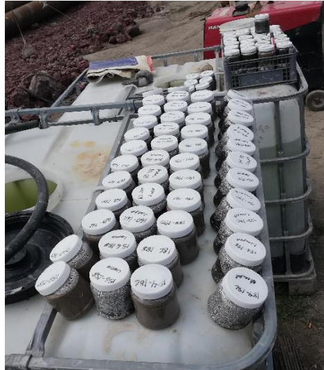
Ilustración 50 Muestras de suelo debidamente lavadas y clasificadas de acuerdo con la profundidad de extracción. Fuente: Elaboración propia.
